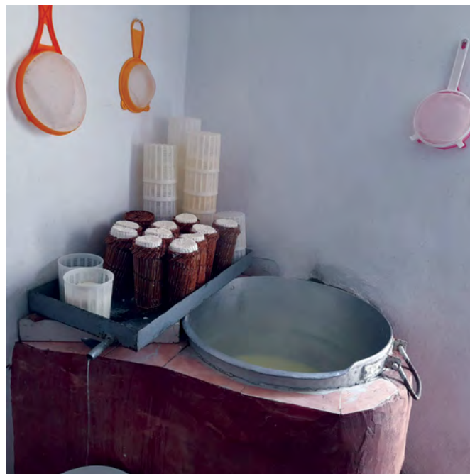
Καζάνι τυροκόμησης κτιστό και δίσκος στράγγισης των τυριών. Τα τυριά είναι τοποθετημένα στα παραδοσιακά τ'ροβόλια και σε σύγχρονα πλαστικά δοχεία.
